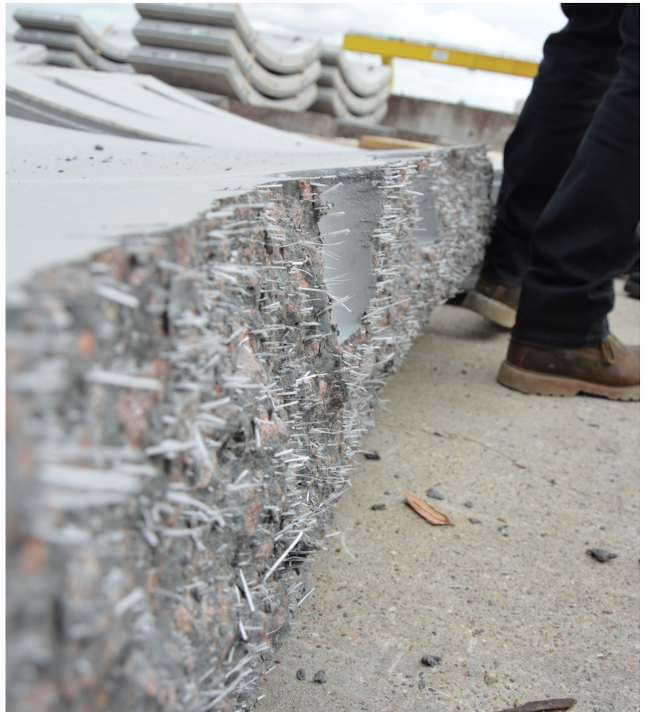
PP Nordicas Durus®EasyFinish i beton er ikke påvirket af fugt og kan dermed ikke korrodere.
